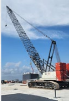
LINKBELT 248 200T 200 Ton Crane
