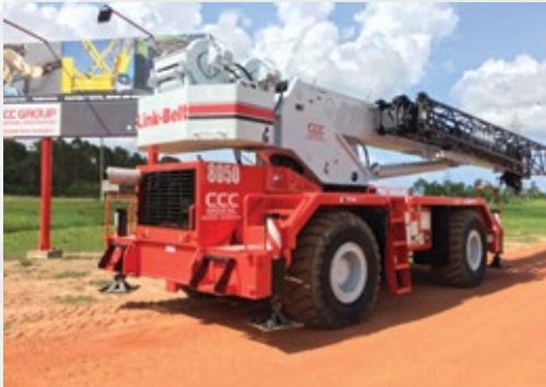
LINKBELT 50T RTC 8050 50 Ton Crane
